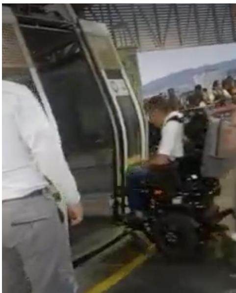
Disminución de velocidad en el Metro cable para ingreso de una persona en silla de ruedas
